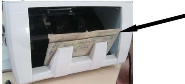
Cuando se produce un error que provoque la detención del conteo, retire todos los billetes y recuéntelos para evitar descuadres.
