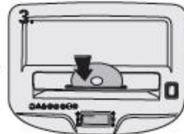
Alimente los Cd y tarjetas a través de la ranura diseñada para este fin. La máquina lo destruirá automáticamente.
