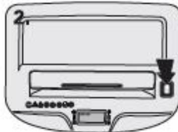
Pulse "I" para poner la máquina en automático. La pantalla LCD mostrará "AUTO START".
